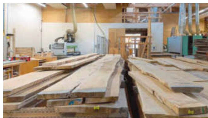
Einfacher, aber besonders effizienter Materialfluss: Die Holzstapel liegen auf Rollwagen und lassen sich zur Säge schieben
