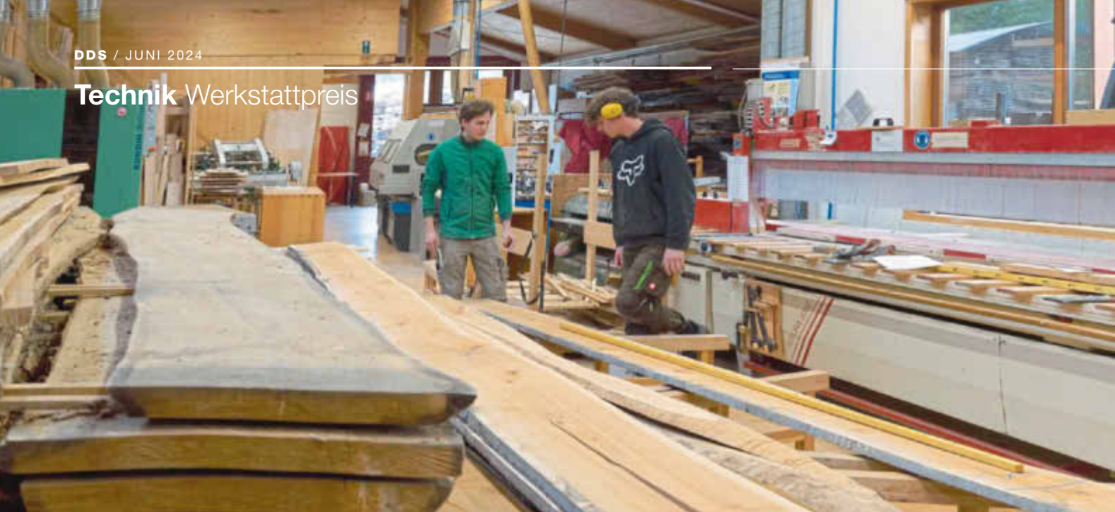
Niedrige Böcke vor der Längsschnittsäge erlauben das Wenden und Kappen der Bretter mit der Kettensäge
